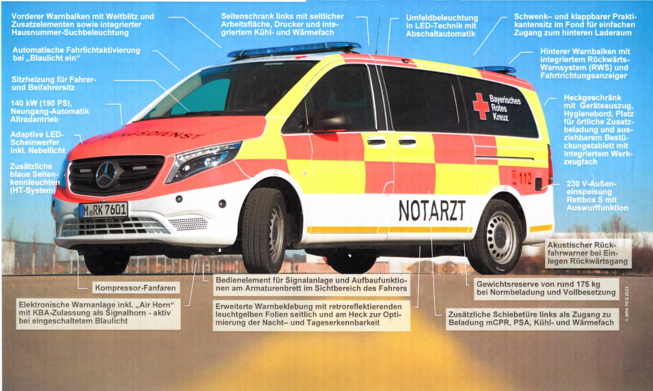
Vorderer Warnbalken mit Weitblitz und Zusatzelementen sowie integrierter Hausnummer-Suchbeleuchtung
