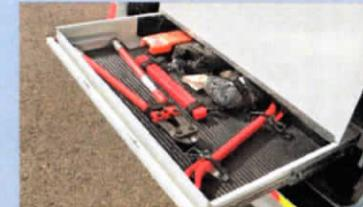
Ausziehbares Bestückungstablett mit integriertem Fach für Bergwerkzeug
